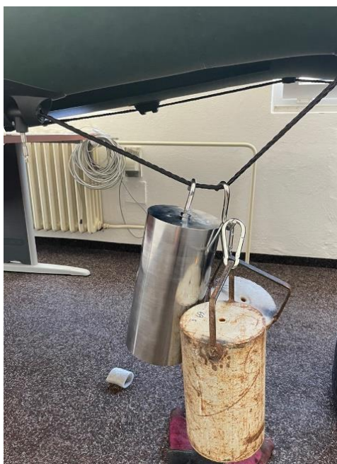
Obrázok č. 6 – Testovanie pevnosti lán a držadiel
